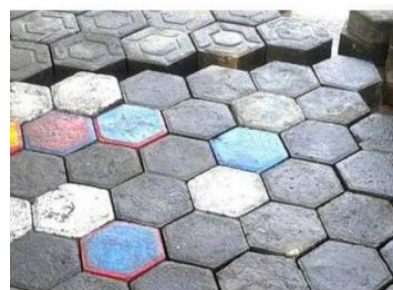
(Gambar 5 : paving block dari sampah plastik)
